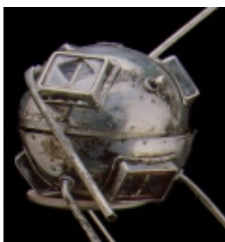
Figura 2: Imagem do Vanguard I, o primeiro satélite com uma célula solar, foi lançado em Março de 1958 levando a bordo um pequeno painel solar com 100cm 2 visível na janela em cima à esquerda.
